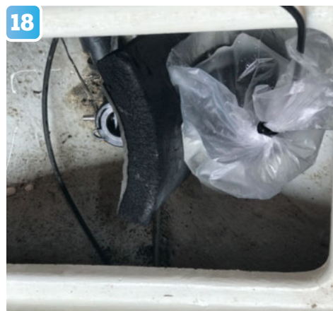
18 Även i utrymmet för om kölen blir signalen bra, och beslutet fattas att här ska den monteras.
