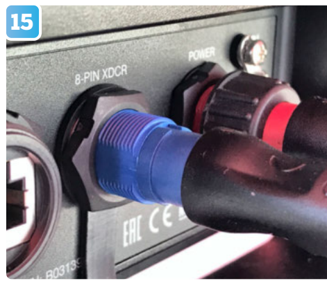
15 När givaren pluggats in i sitt jack startas plottern och ekolodsgivaren kommer igång i sin påse.
