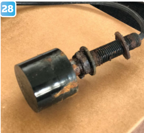
28 När givaren avlägsnas faller den delvis i bitar. Inte konstigt att det inte fungerade i slutet.
