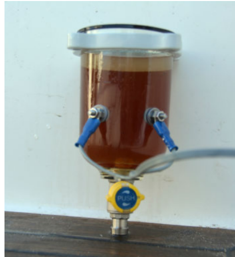
När vattennivån i koppen stiger upp till elektroderna sluts strömmen och larmet går, både med ljus och med ljud.
