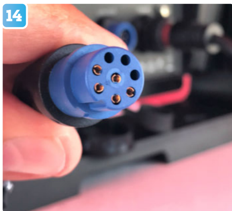
14 Givarens kabel dras fram till plottern.
