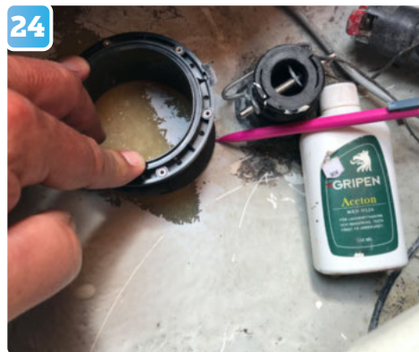
24 Nu riktas givartanken in noggrant med dess pil mot kölvinkeln.
