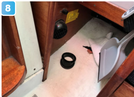
8 Nedanför navigationbordet akterut skulle också funka, men givaren skulle dels vara lite i vägen, dels lite för långt akterut för att kunna se framåt. Dessutom kan det vara mer turbulens i vattnet där.
