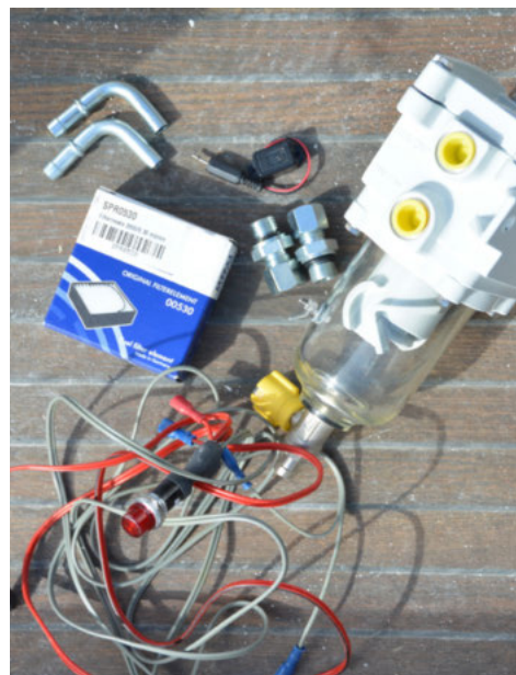
Delarna som behövs: filterhållare, filter, adaptrar och vattenlarm med lampa och summer.
