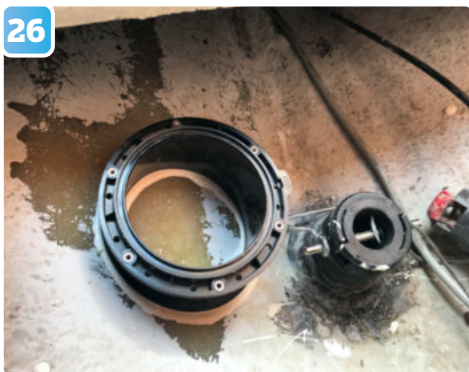
26 Sedan vänds tanken rätt och placeras snabbt på sin plats. Överflödigt Sikaflex torkas bort. Nu ska detta hårdna i 24 timmar.
