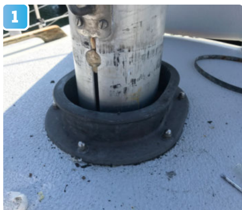
1 Första steget är att ta bort alla rester av tidigare mastkrage och eventuellt kvarvarande lim.
