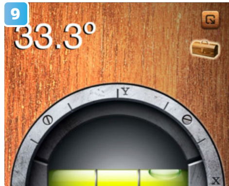
9 En app i mobilen funkar som vattenpass på de olika platserna. 33 grader är alldeles för mycket.
