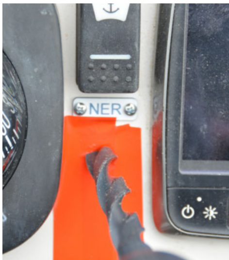
Larmet borras in på en plats där det syns tydligt, i vårt fall i piedestalen.
