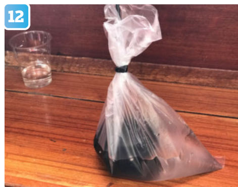
12 Givaren placeras i påsen, vatten fylls på och påsen kläms ihop runt kabeln för att minimera risken för spill.
