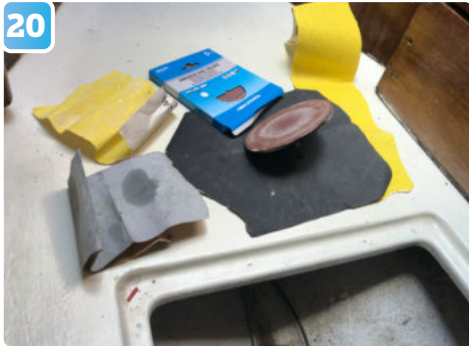
20 Dags att förbereda givarens plats, och till det behövs sandpapper i olika grovlekar. Ytan ska vara så jämn som möjligt och 240-papper ger önskad finish.
