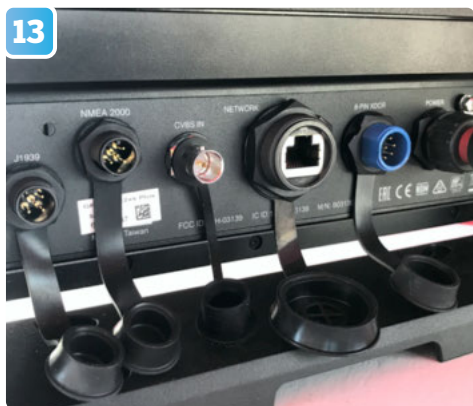
13 Den nya plottern, som har stöd för ekolod, monteras på sin plats och kopplas in.
