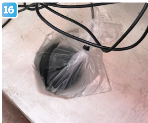
16 Påsen med givaren placeras på olika ställen för att se om signalen blir ren och fin på plottern. Om det är luftbubblor i laminatet kommer det inte att bli bra.
