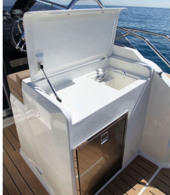
Modulen som innehåller sittbrunnskök med kylskåp, diskho och förvaringsutrymme är sammanbyggd med förarsoffans baksida och kostar 35 000 kronor extra.
