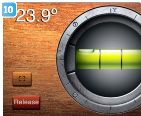
10 23,9 grader är helt okej eftersom max-vinkel för monteringsstanken är 25.
