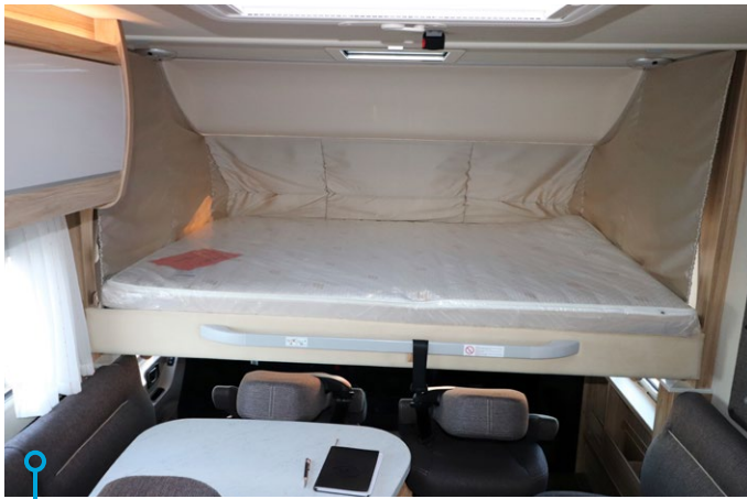
Den nedfällbara taksängen kan vara nedfälld samtidigt som det går att vistas i sittgruppen.
