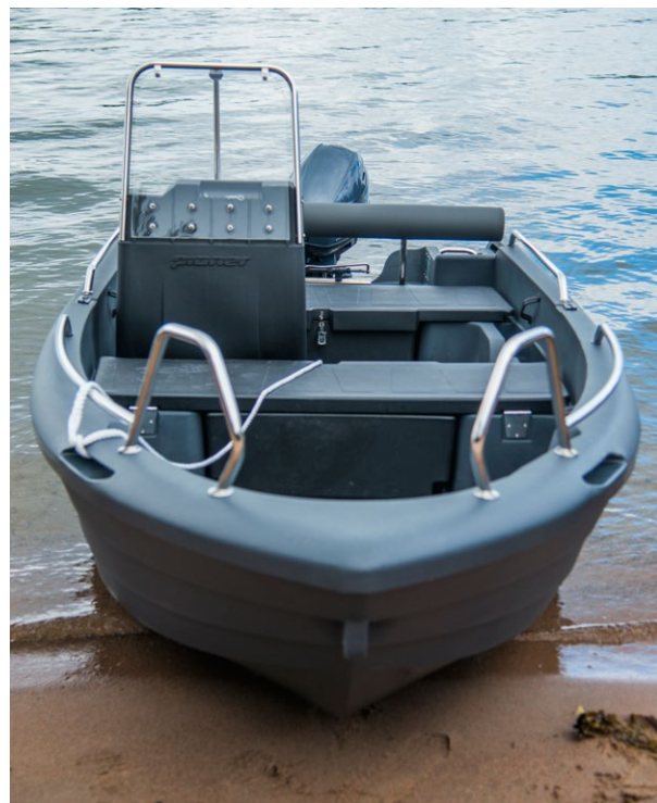
▲ Det rotationsgjutna plastskrovet är tåligt mot stötar och slag. Om en skada ändå uppstår, går det att laga med en värmepistol och en ny plastbit.
