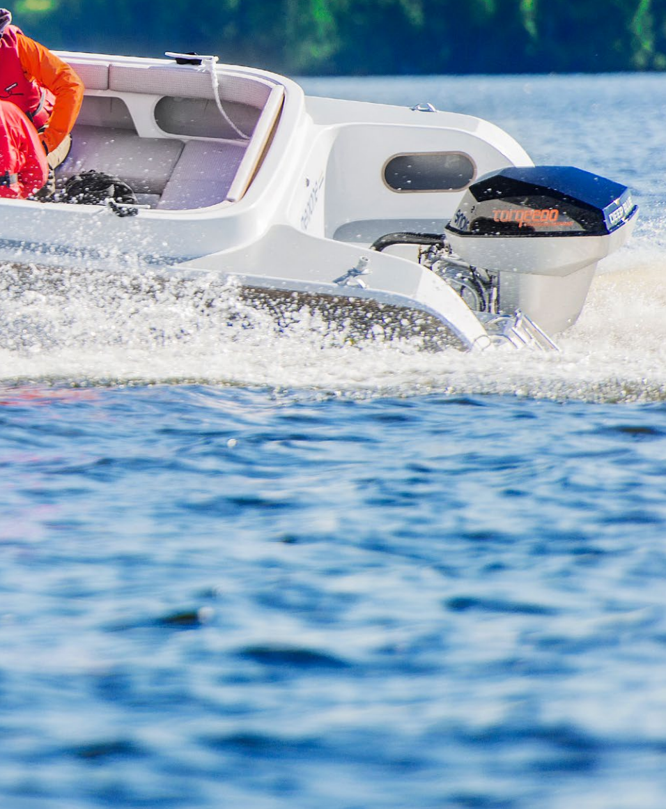
▲ Torqeedos elmotor levererar 80 hästkrafter, är relativt tyst och ger en ordentlig acceleration.
