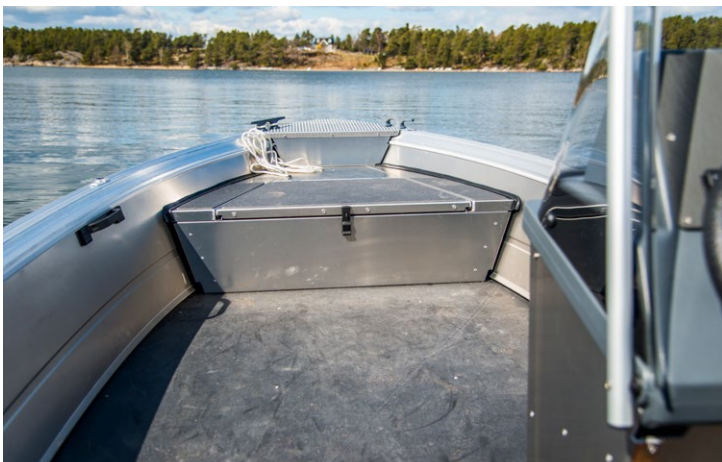
▲ Buster S1 har självlänsande durk. Praktiskt, men det ger också något mindre innerutrymmen eftersom durken hamnar högre upp.
