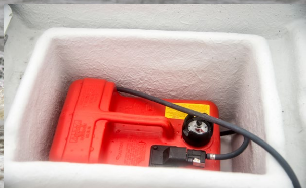
▲ Bensintanken ligger i aktertoften och ger många sjömils räckvidd. Med närmare 20 knops toppfart och sjövärdigt skrov kommer du snabbt långt.
