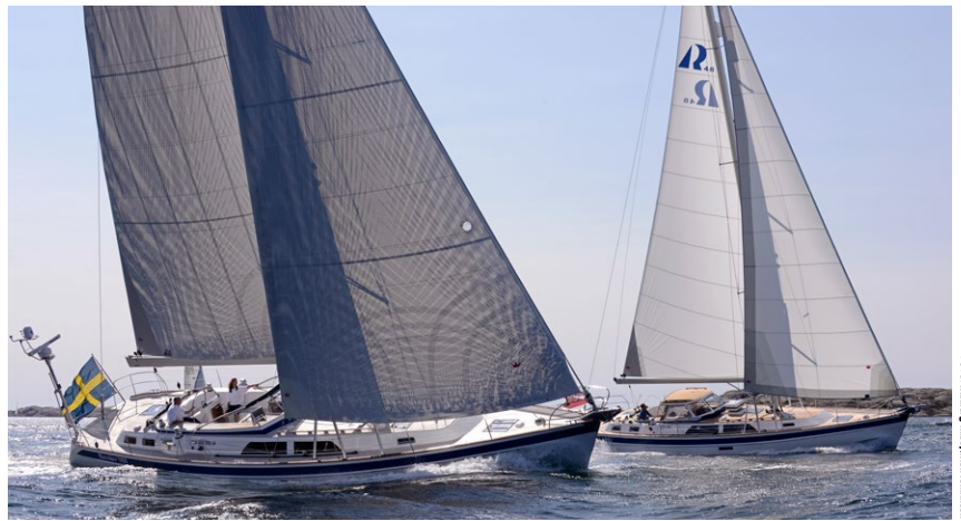
▲ Elvström Sails har utvecklat rullstorseglet fatturl, som här syns på en Hallberg-Rassy 55 närmast kameran. Skillnaden mot ett traditionellt rullstorsegel, som på Hallberg-Rassy 48 MkII i bakgrunden, är påtaglig.
