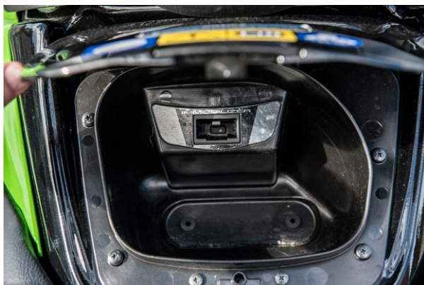
▲ I handskfacket kan du förvara mindre prylar. Här sitter också den elektroniska startspärren som även kan användas för att minska kraften i skotern.
