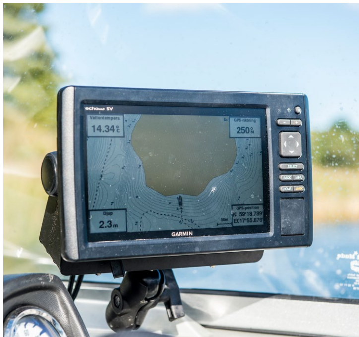
▲ Ekolodet är ett måste om du vill leta efter fisk. Fästet gör att du kan vrida det i den riktning där du behöver se det. Läs mer om hur du använder ekolodet på sidan 72 i detta nummer.
