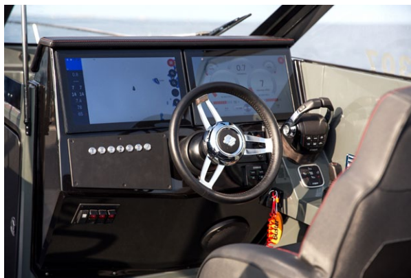
▲ Dubbla plottrar ger en tydlig koll på terräng och båt. Sikten är god och rätt och gasreglage bekväma.
