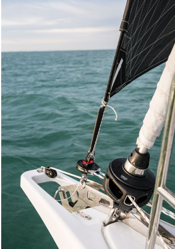
▲ Fock, code eller gennaker, alla tre varianterna av försegel har sin egen infästning i fören på Dehler 34, bara att välja efter vindvinkel och vindstyrka.
