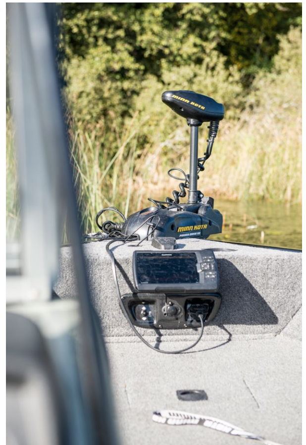
▲ Elmotorn kan både användas för att hålla båten still samt till att styra den i olika mönster. Den styrs med fjärrkontroll eller från navigatort.
