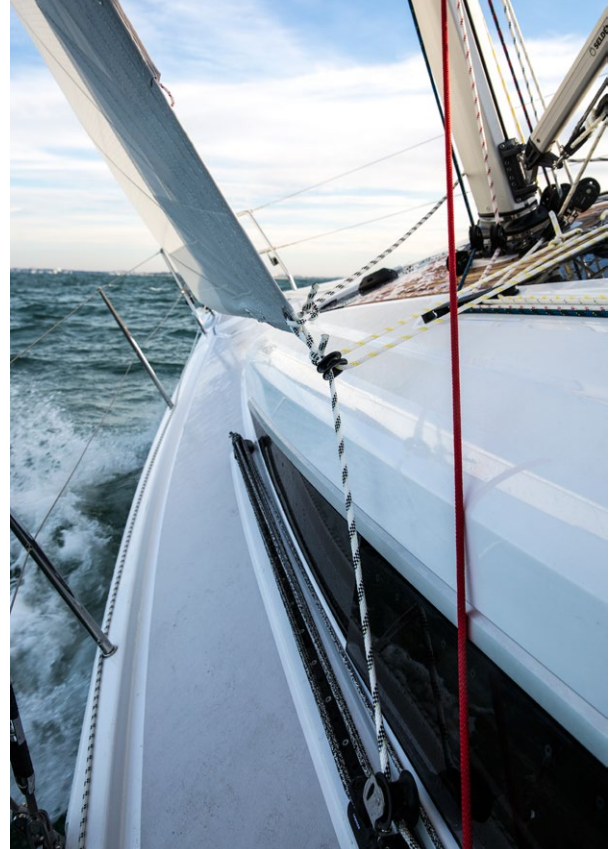
▲ Fockbarberhau med lågfriktionsringar för att justera seglets vinkel är snart lika självklara som steglöst trimbara fockskotstravare.
