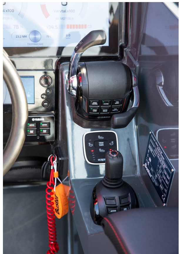
▲ Med Yamahas elektroniska drive-by-wire-system Helm Master och joystickstyrningen är manövrering i trånga utrymmen enkel.
