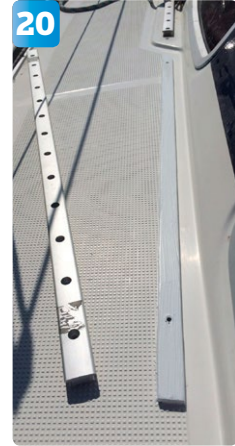
... för att limma fast den nya genuaskenans innanför maskeringen. Han gör likadant på styrbords-sidan.
