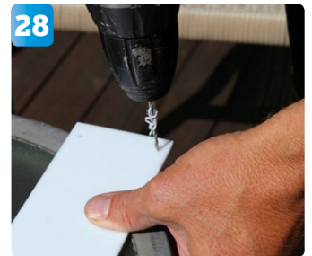
28 Därpå borrar jag hål för att lättare kunna skruva fast luckorna i modulerna.
