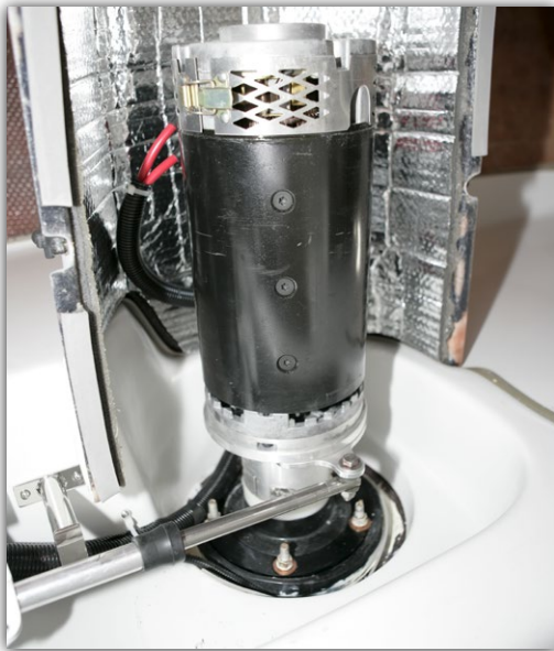
Motorn är en marinpassad golfbilsmotor, mycket av tekniken kommer från just golfbilar.
