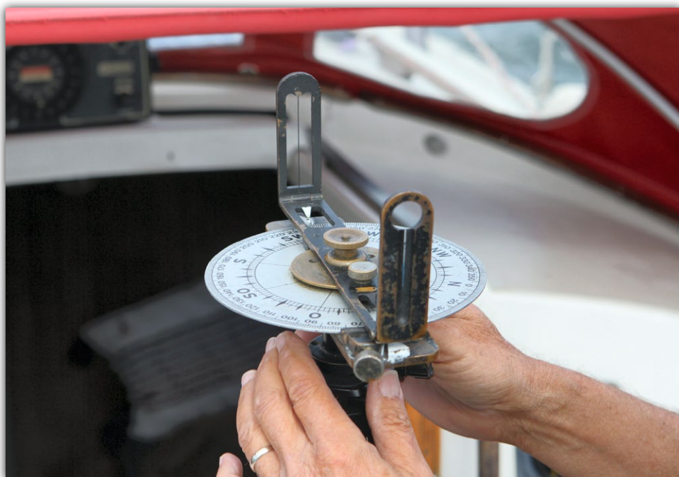
Kompassjusteraren Mikael Olin använder en pejlskiva och för honom kända landmärken som referenspunkter.
