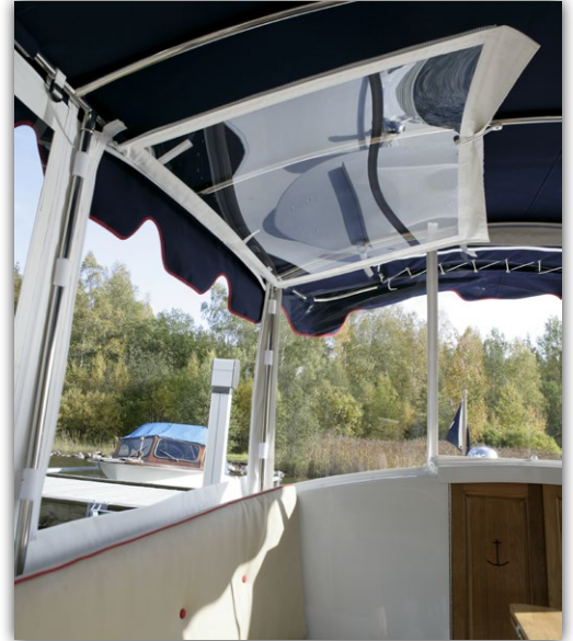
Kapellsidorna fälls upp i taket när de är öppnade, smart lösning.
