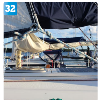
32 Skotvinkeln är mycket bättre och framgent kommer genuan att kunna skotas planare.
