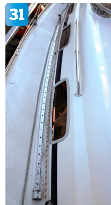
31 På varje genuaskenorna drar jag igenom en skotlina genom travaren. Klart.
