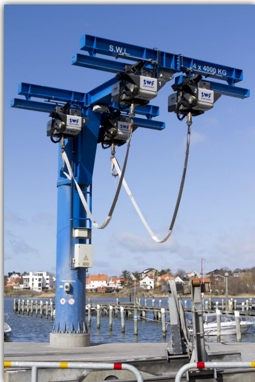
En av Grefabs moderna kranar i Göteborg. Denna lyfter upp till 12 ton.
