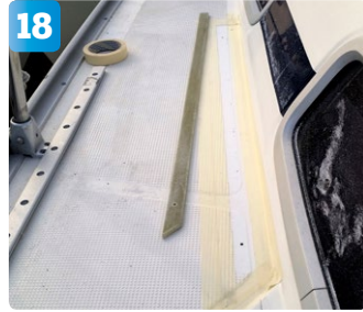
18 Niklas mäter var den nya skotskenan ska monteras. Skenans upphöjning byggs upp med glasfiberlaminat. Originalskenans ändstopp plockas bort och ytan som ska skyddas maskeras. Gelcoaten slipas innanför maskeringen.
