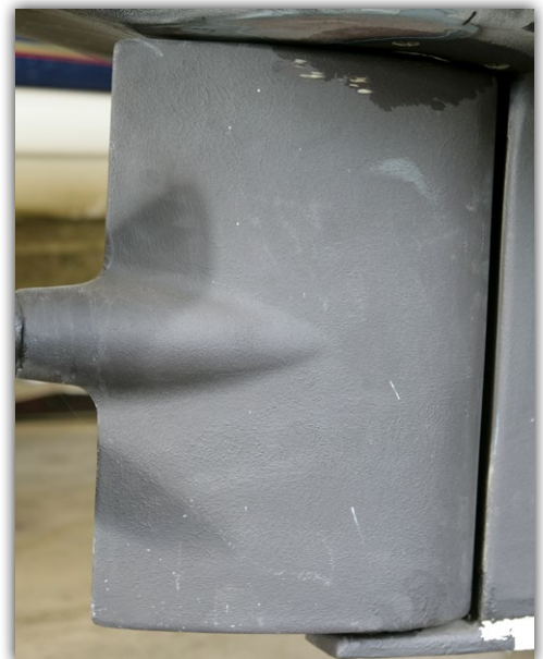
Propellerns placering ser lite rolig ut men ger väldigt bra manöveregenskaper.
