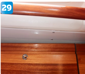
29 Luckorna skruvas fast med rostfria skruvar. Eftersom luckorna är lite transparenta går det att montera en LED-lampa ovanför.
