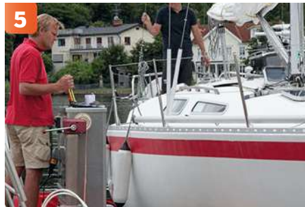
5 Hela tvättförloppet kontrolleras av en maskinist som styr borstarnas läge och båten's hastighet genom maskinen.
