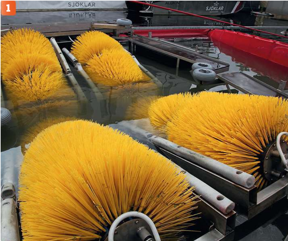
1 Den här maskinen har fyra flexibla borstar i ytläge som följer båten's skrovform plus två vertikala borstar. Den klarar kölbåtar med upp till två meters djup.
