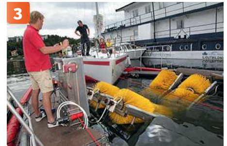
3 När fören närmar sig de första borstarna startas maskinen.
