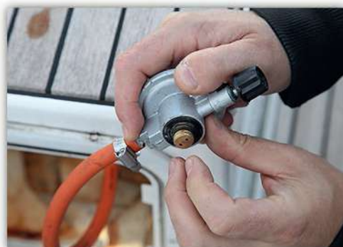
Packningen mellan reduceringsventil och flaska ska vara mjuk. Är den sprucken, byt direkt. Annars tar flaskan slut onödigt fort.
