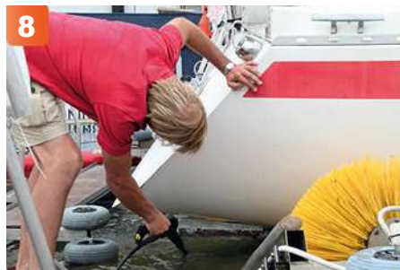
8 Roder och andra detaljer, som utombordare, drev, akterspegel, tas manuellt med högtryckstvätt.
