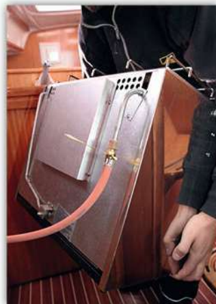
Slangen vid spisen bör bytas efter tre till fem år. Ibland finns en gul märkning som visar vilket år slangerna ska bytas igen. Märkningen på slangerna är tillverkningsåret.
