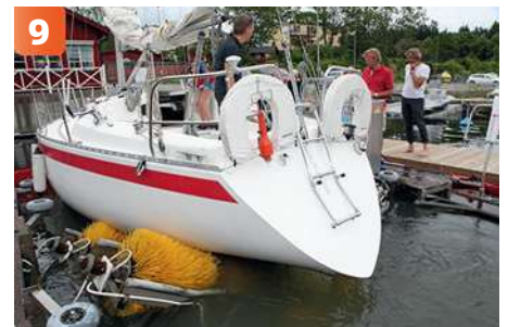
9 Båtbotten tvättas även en extra gång när båten backas ut. Det har gått ungefär 15–20 minuter och borsttvätten är redo för nästa båt.
