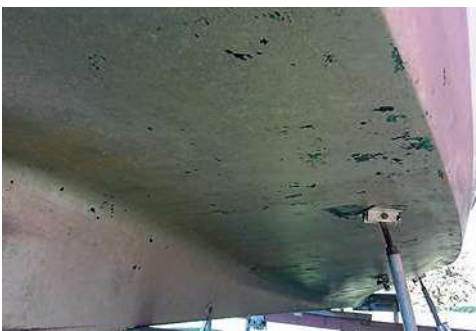
Folkparca 22. Flagor hade lossnat under säsongen och färgen släppte ytterligare vid högtryckstvätt.
