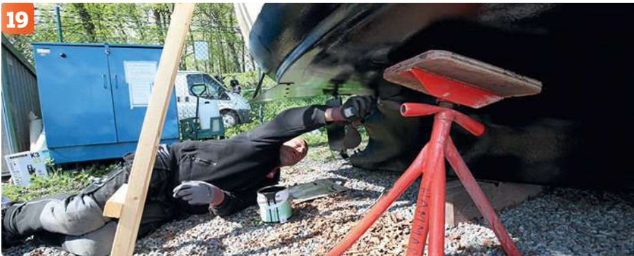
19 Stöttorna skruvas ner en bit så att det går att måla hela botten. Men Ove låter dem stå kvar som en extra säkerhet.
