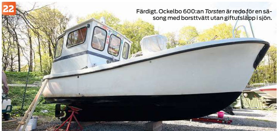
19 Stöttorna skruvas ner en bit så att det går att måla hela botten. Men Ove låter dem stå kvar som en extra säkerhet.
