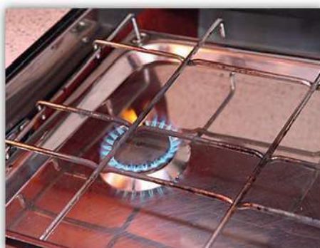
Gula inslag i lågan betyder ofullständig förbränning, vilket skapar kolmonoxid. Spisen behöver servas.
