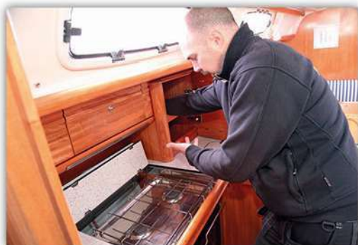
En separat avstängningskran ska sitta vid varje apparat. I den här båten sitter avstängningen bakom spisen, inte helt optimalt.
