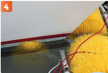
4 Här syns en av de vertikala borstarna till höger, som tar hand om kölen.
