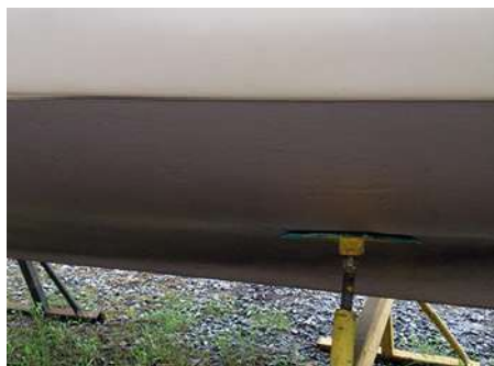
Albin 25 före sjösättning. Spärrfärgen Nautical Underwater Primer målades direkt på tidigare bottenfärg utan särskilt noggrant förarbete.
