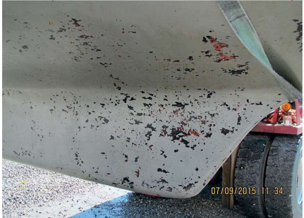
Magnifik Midget efter högtrycksspolning, där färgen släppte fläckvis.
