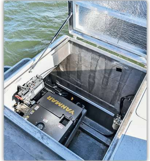
Vårt testexemplar är utrustat med 2 x 150 hk Yanmar. Det ger en marschfart på 19 knop.
