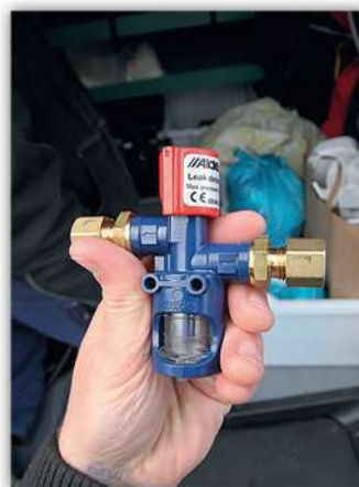
En läckageindikator med bubbelkopp är lätt att använda, billig i inköp och har en pålitlig funktion.
