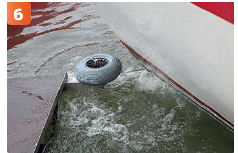
6 Gummihjul ser till att båten ligger rätt i maskinen.
