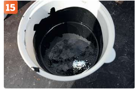
15 När tvåkomponentsfärgen blandats är färgen full av små bubblor. Måla inte med färgen förrän bubblorna försvunnit, annars finns risk att den målade ytan inte blir jämn.
