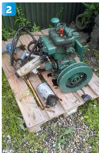
2 Den gamla originalmotorn med backslag, som tillsammans väger in på 150 kilo, har gjort sitt.
