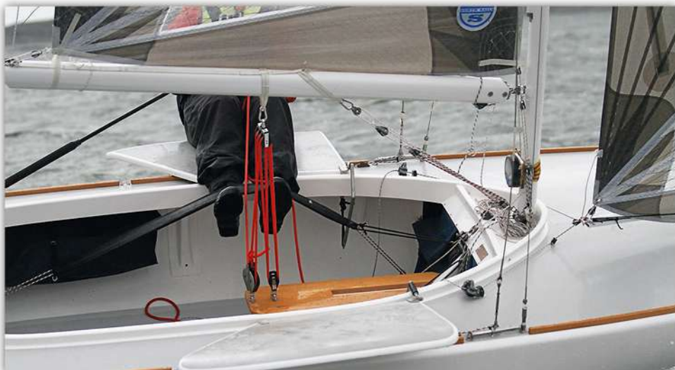
Riggen är av kolfiber, väger bara 6 kilo och har många möjligheter till trimning och segelsättning.
