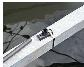
Stången till Mr. Mooring gick rakt av i testet.
