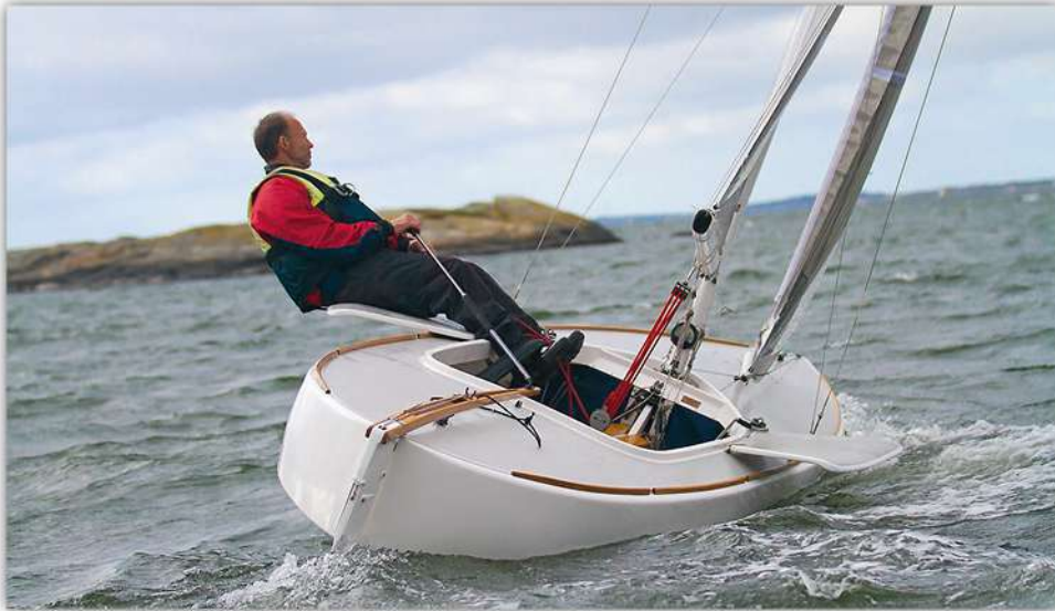
Segelkanoter skiljer sig från jollar däri att både för och akter är spetsiga. D-kanot har dessutom barlast.
