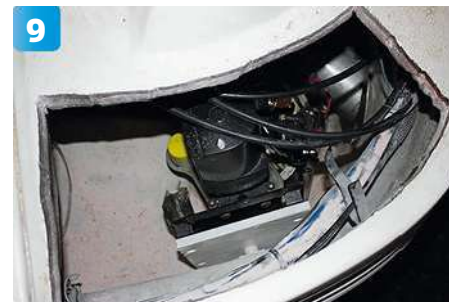
Trimmotorn monterar på sin nya plats. Hålet ska täckas med polywood och flexiteek nästa år.
