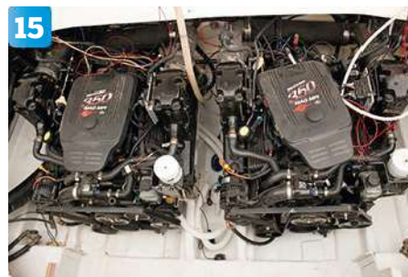
15 I samma veva avfettas och tvättas hela motorrummet grundligt. Därpå rollar Victor på fem lager epoxi. Mellan motorerna förbereder han för att installera två nya läns-pumpar som startas med hjälp av sensorer.
