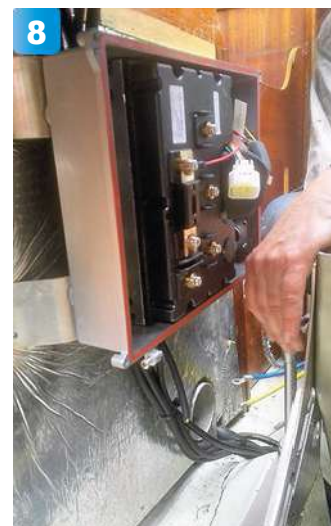
8 Motorstyrboxen placeras på ett intelligande skott. På grund av styrboxens höga verkningsgrad behövs ingen fläktkylning. Däremot är det bra om luft kan cirkulera runt den. Därför monteras boxen på bågar av aluminium.
