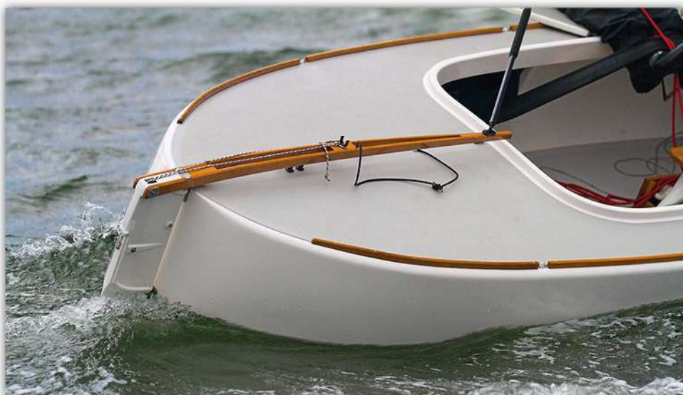
Aktern är spetsgattad, men tack vare ett slag i skrovet strax under vattenlinjen kan segelkanoten plana.
