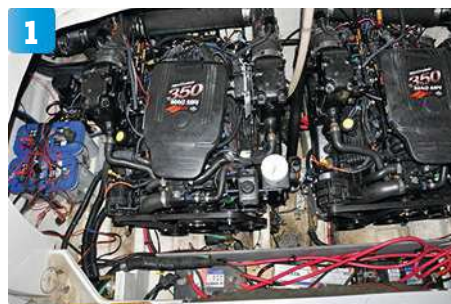
Motorrummet med de dubbla bensinmotorerna 350 hk Mercruiser 5,0 Mpi är i originalskick. Tre underhållsbatterier är placerade närmast sittbrunnen medan de två startbatterierna är placerade på styrbordssidan. Några kablar är felkopplade.
