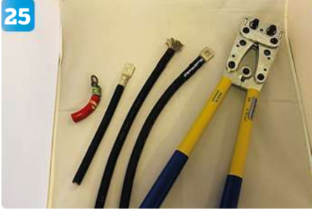
25 Kabelpresstång är A och O under arbetet.
