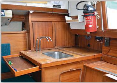
En djup diskho med kranar för sjövattnen och färskvattnen var ett lyft 1966 jämfört med lösa plastbaljor och att diska i sittbrunnen. Utdragbar skiva var ett sätt att öka avställningsytan.
