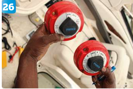
26 De gamla strömbrytarna ska monteras på plats.
