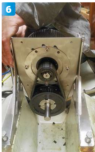
6 Nästa steg är att montera fast motorn i stativet. Det finns många justeringsmöjligheter, så drivaxel och remspänning kan ställas in exakt.
