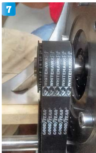
7 Den borstlösa motorns varvtal växlas ned med en så kallad HTD-rem för att ge ett lämpligt propellervarvtal. Växeln ingår i motorpaketet.
