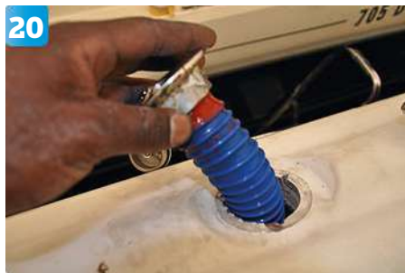
20 Alla slangar till septiktanken byts ut.
