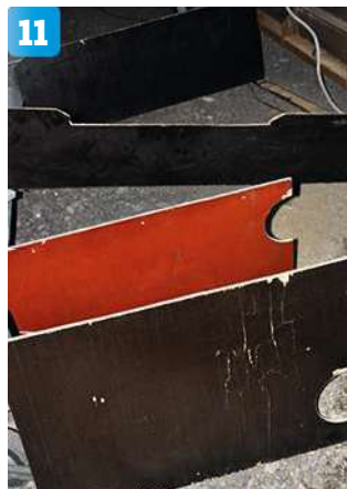
Nästa steg är att kapa nya skott av marinplywoodskivor som ska placeras i motorrummet.
