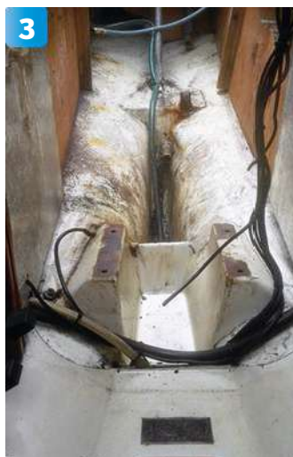
3 Motorrummet är tomt. Nu ska oljerester och smuts tvättas bort.
