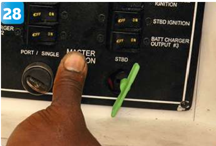
28 Med den här gröna strömbrytaren kan Victor koppla samman startbatteribanken med förbrukningsbanken.
