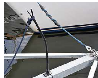
Stången till Hang Up gick inte av, men den böjdes och var sedan inte sig lik.
