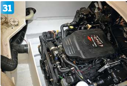
31 Victor passar också på att montera ett luftrör från värmaren genom motorrummet för att hålla det fuktfritt när båten inte används, via GSM-start.
