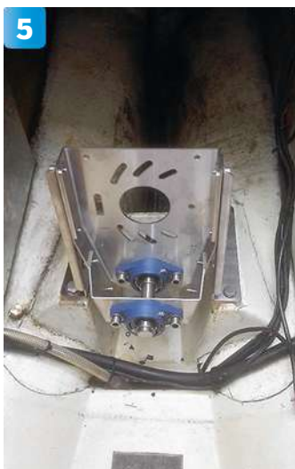
5 Det första steget är att montera motorstativet på plats. Hålen i stativet passar perfekt till hålen från den gamla motorn i motorbådden. Till och med de gamla bultarna kan återbrukas.
