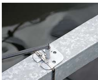
Stången till Hands Upp är gjord av glasfiber. Därför splittrades den i böjningstestet. Den går i och för sig att kapa och sätta dit på nytt om inte stången sjunker innan dess.
