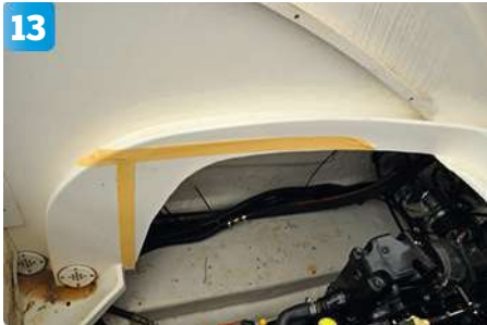
13 En del av modulinsidan i motorrummet skärs upp för att få plats med nya rostfria förvaringsboxar.
