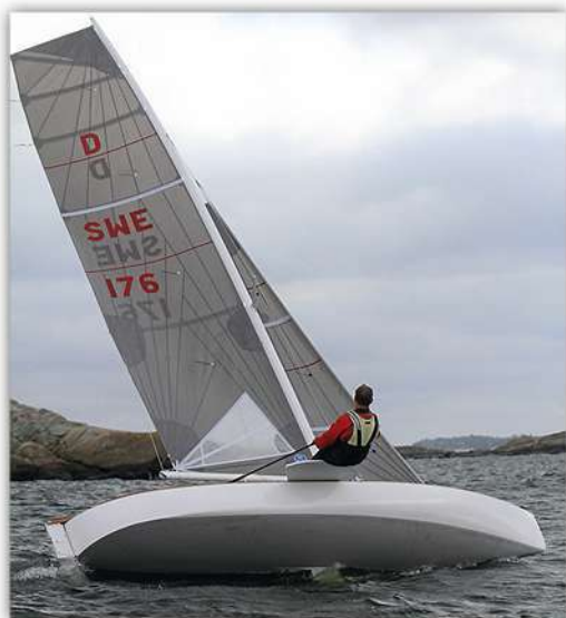
Tejst har ett centerbord med 30 kilo bly inbyggt. I skrovbotten ligger ytterligare 150 kilo.
