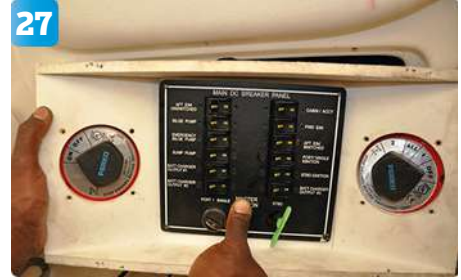
27 Från de två startmotorerna dras 70-kvadratskablar till de två strömbrytarna som monteras fast i en panel. Med den ena "On-off-brytaren" kan Victor slå på ström till de dubbla motorerna. Med den andra "1+2-all-brytaren" kan han välja vilken underhållsbank han vill ladda, eller ladda båda.
