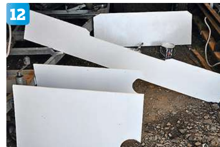
Skivorna målas med fem lager epoxi.
