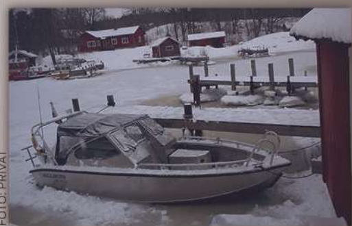
Många låter sina aluminiumbåtar ligga i vattnet under vintern. Men om en aluminiumbåt ligger förtöjd i en isfri hamn, kan cirkulationspumpar ge läckström som i sin tur skapar korrosion. Som aluminiumbåtsägare ska man vara extra noga med att hålla koll på sina offeranoder.
