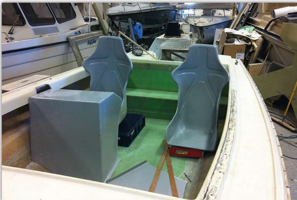
Båtens omdisponerade inredning börjar ta form. Notera den helt nyttillverkade styrpulpeten. I bakgrunden syns aktersoffan innan den är uppsågad och försedd med gångjärn.
