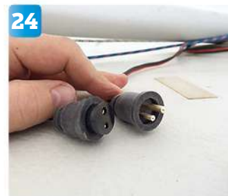
24 Den portabla solcellspanelen får en ny kontakt, med motsvarande hane i fast monterad kabel under sprayhooden.
