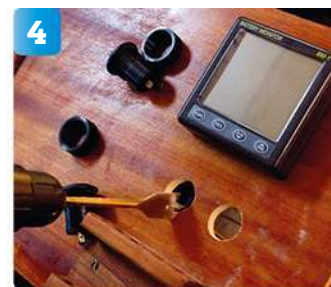
4 Här har Nasacentralen hittat sin plats och två hål borrar för de nya 12 V-uttagen.
