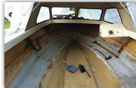
Drygt 50 timmars jobb med kofot, barkspade och Fein Multimaster-maskin krävdes för att göra skrovet soprent invändigt.
