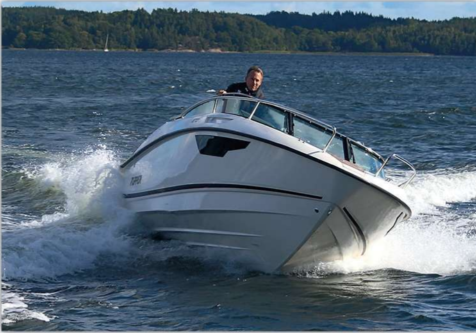
Flipper 670 DC är anpassad till motorer mellan 135 och 250 hk. Med 250 hästkrafter i ryggen kommer föraren upp i 44 knop.
