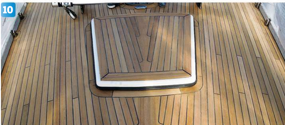
10 Så här ser det nylagda, vakuumlimmade teakdäcket ut på Hans Nymans båt.
