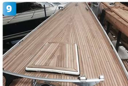
9 Teakdäck klart. Mastfot, block och andra beslag monterade.
