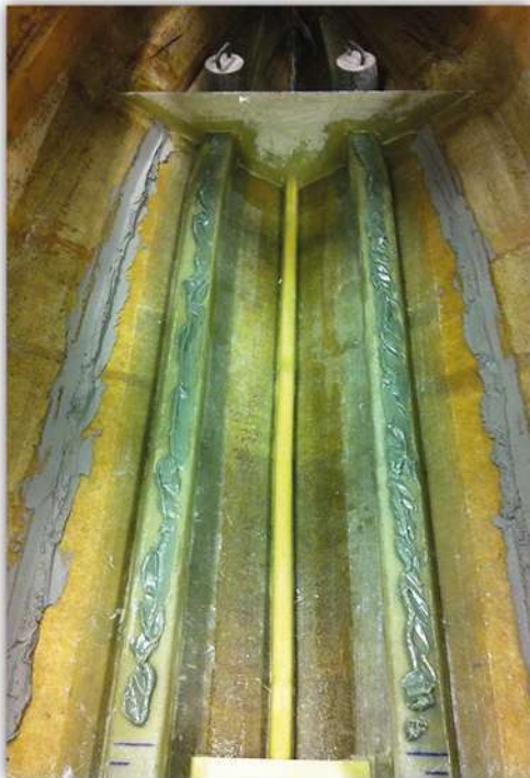
Här syns det nya skottet under HT:n och den nya mittstringern. Strax ska durken i sandwichlaminatet monteras i polyesterspackel för att ge skrovet ökad vridstyvhet.
