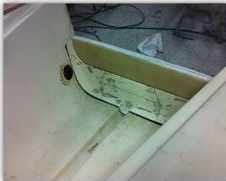
Akterspegeln tillverkades i glasfiber, Ferrettimatta och polyester. Delar av motorbrunnen sågades ur för att underlätta jobbet.
