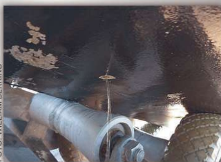
När aluminiumbåten, byggd 2009, under en besiktning torsattes upptäcktes ett vattenläckage genom skrovbotten. Orsaken var dålig aluminiumkvalitet kombinerat med en läckströmskorrosion. Inspektionssluckor för att upptäcka läckan saknas.
