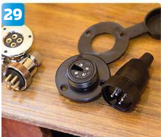
29 Multikontakten här till höger blev betydligt bättre. Lätt att montera och omöjligt att sätta den fel.
