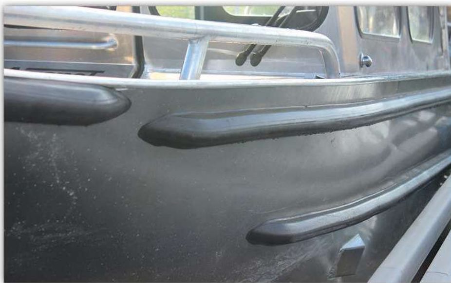
Skrovsidorna är utrustade med kraftiga avbärarlistor av gummi.
