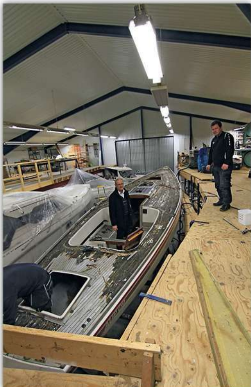
Hans Nyman byggde båten själv 1978 och lade även teakdäcket på egen hand. Efter mer än trettio års användning och slitage var det nu dags att byta.
