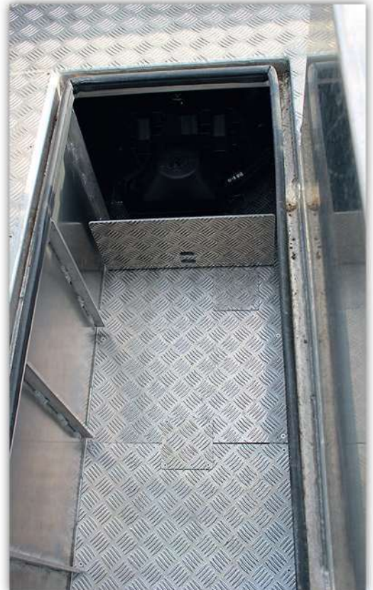
Ett rejält stuvfack på akterplattformen. Här inne finns batteribanken.
