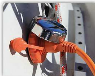
Det översköljningssäkra elintaget för landström på babordssidan av rufftaket.
