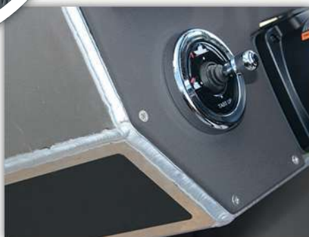
Intill instrumentpanelen finns det en joystick som föraren kontrollerar trimplanen med.
