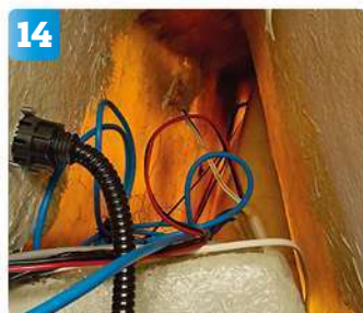
14 FM-antennen hade i många år legat och skramlat i babordsskåpet. Det finns dock flera "glömda" utrymmen i en Ballad, som här mellan rufftak och skarndäck, perfekt för att sticka in den fullt fungerande antennen.
