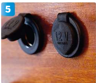
5 De två 12 V-uttagen på plats i panelen. Det ena får även en dubbel USB-insats.
