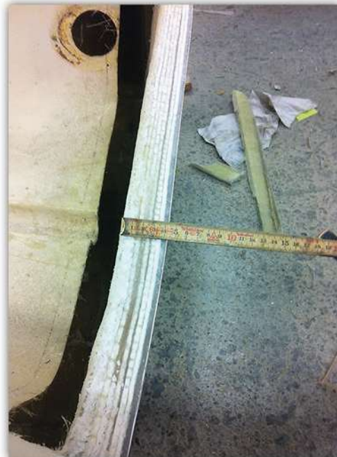
Med delar av motorbrunnen bortsågad gick det att komma åt och laminera en ny akterspegel. 45 millimeter tjock och 13 centimeter högre än originalet för att matcha Veradons XL-rigg.
