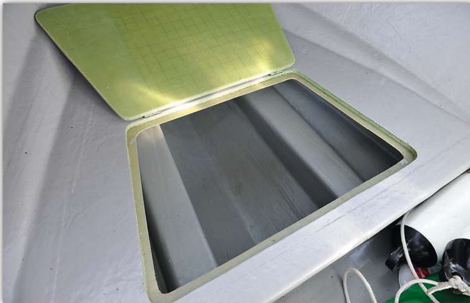
Notera tvärskeppsskottet som tillsammans med horisontella skivan och bottenbalkarna utgör en bärande del av konstruktionen. Allt för maximal vridstyvhet och utnyttjande av varje kilo material.
