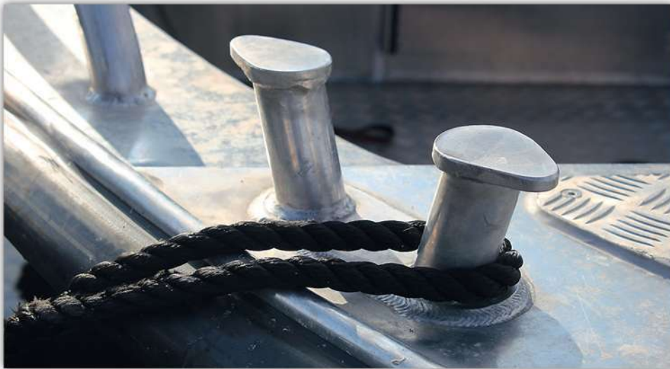
De bastanta pollarna av aluminium är fastsvetsade.
