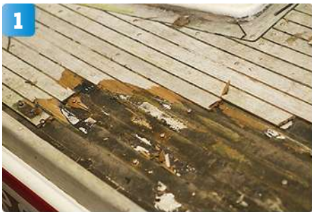
1 Det gamla teakdäcket har gjort sitt och plockas bort, ribba för ribba, skruv för skruv.
