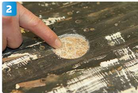
2 Borrprov görs runt omkring däck, och på vissa platser är sandwichen torr och frisk.
