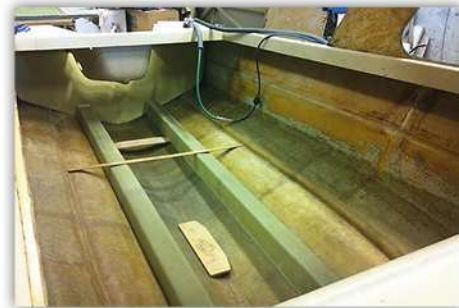
Kalle Pettersson på Segmo Plast tog över stoffpinnen när ett jobberbjudande som inte gick att avböja dök upp. Kraftiga bottenstockar från Segmo 31, fler stringers och ett par extra skott tillkom på hans inrådan.
