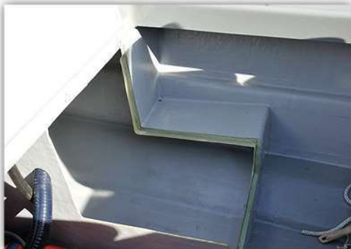
Skottet i aktern och akterspegelsknäna utgör tillsammans med med aktersoffan en bärande och förstyvande del av konstruktionen.
