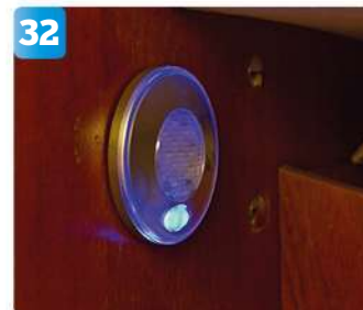
32 De ersattes med dessa LED-armaturer från Biltema, med en blå diod i knappen.
