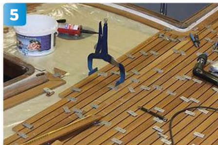
5 Här läggs nya teakribbor som tillfälligt skruvas fast i båtens däck och samtidigt pressas och permanent limmas fast i varandra.
