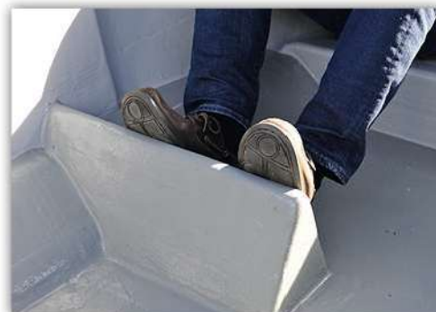
Fotstöden i durken är placerade och utformade så att de gör nytta för både navigatören och de passagerare som bänkats under HT:n.
