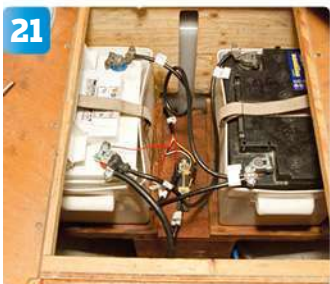
21 Allt klart i förbrukningsbankens utrymme. Nu kan vi lägga på locket.
