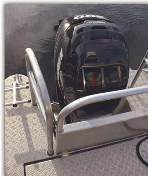
Akterplattformen är utrustad med flyttbara räcken. Under fötterna finns trimplan med is-skydd.
