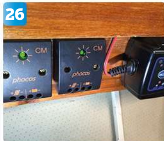
26 Med både den fasta och den portabla solpanelen inkopplade lyser båda laddningsregulatorerna upp – laddningen fungerar. Även 230 V-laddaren är här inkopplad och indikerar laddning.
