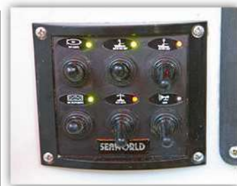
Switchpanelen i sittbrunnen. Allt inkopplat utom tuta, som får bli ett framtida projekt.
