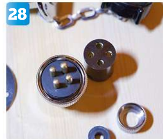
28 Mastens kablar hade tidigare en multikontakt av samma typ som denna, men defekt. En ny av samma sort köptes in men kasserades. Den är rund och alla stift är nästan lika tjocka.
