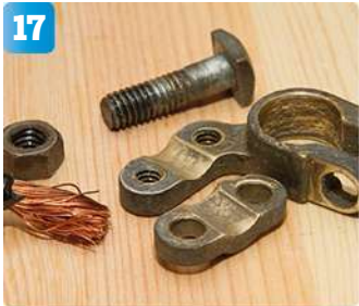
17 Vissa kablar var friska en bit in och ett par kabelskor kunde efter rengöring återanvändas.
