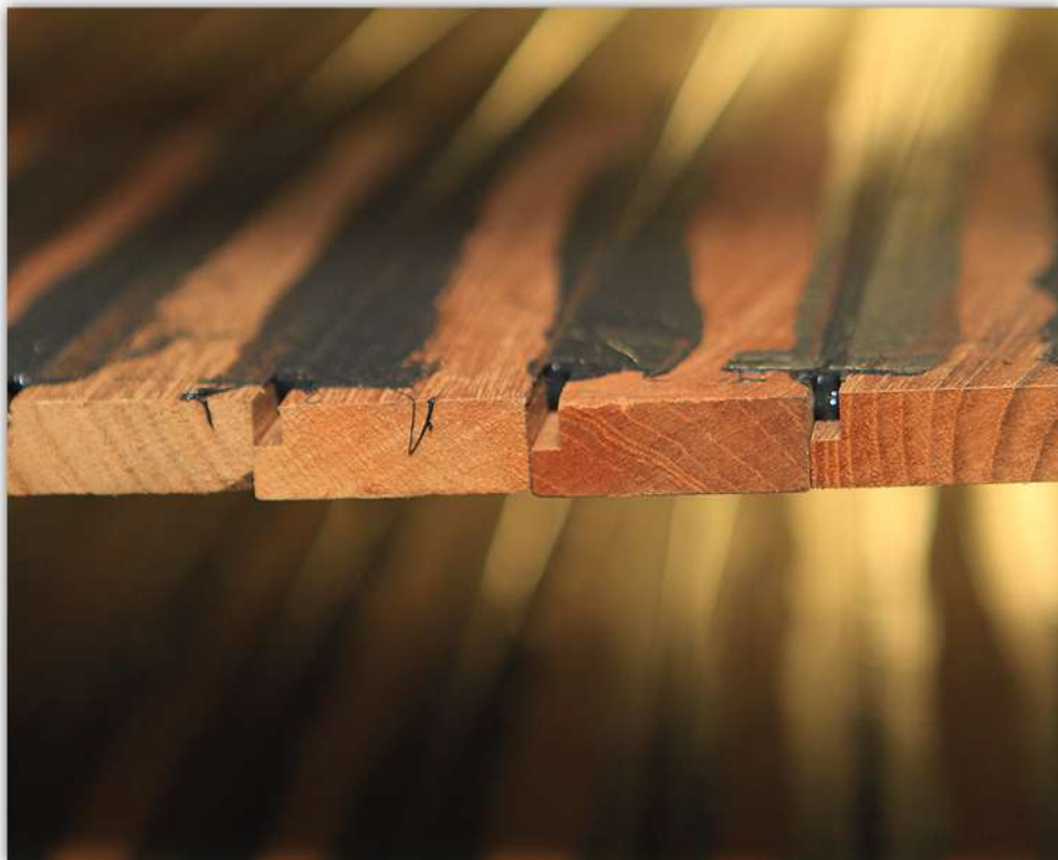
Dessa teakribbor är av traditionell profil och skruvas fast i däck. De små rummen mellan ribborna fylls med nåtmassa. Kais ribbprofil får vi inte visa på bild men är i grunden liknande denna, fast har en delvis överlappande funktion.
