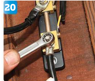
20 Här fästs minuskabeln till all förbrukning ombord. Den passerar alltså shunten, en förutsättning för att batteriövervakningen ska kunna räkna ut korrekta värden.
