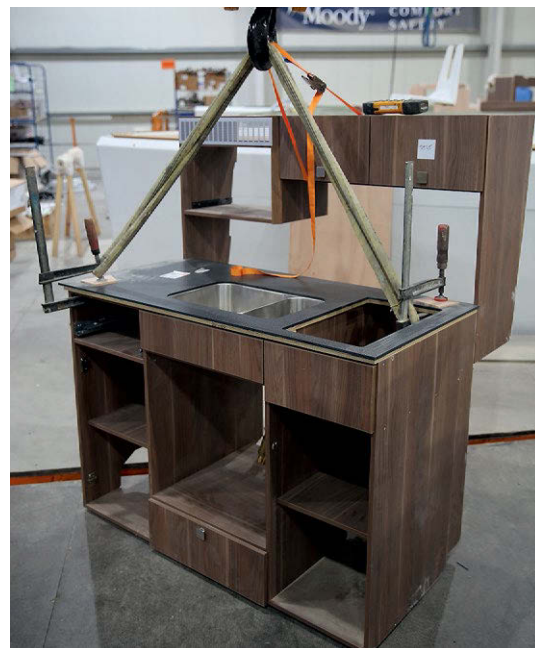
BYGGSATS. Det mesta av snickerierna byggs i moduler som sedan hela lyfts på plats i skrovet, innan däckets läggs på som ett lock.
