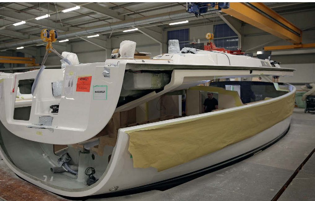
LOCKET PÅ. Det är millimeterprecision när däckets ska sammanfogas med skrovet, som här på en Hanse 455. Flera män på utsidan och några inuti båten kollar att allt är på rätt ställe med god passform, innan limmet stryks på och däckets slutligen sänks ner.
