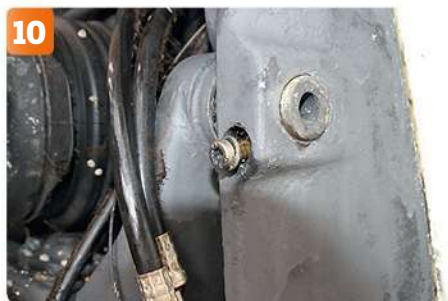
10 Skruva sedan ur låsskruvarna som håller spindlarna/tapparna som drevet hänger i.
