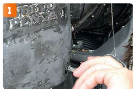
1 Börja med att lossa sex torxsruvar som sitter på sidorna av kåpan.
