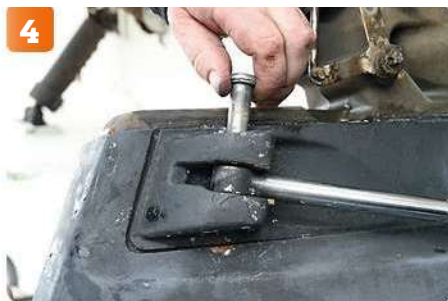
4 Plocka loss tapparna i båda ändar av styrcylindrarna.
