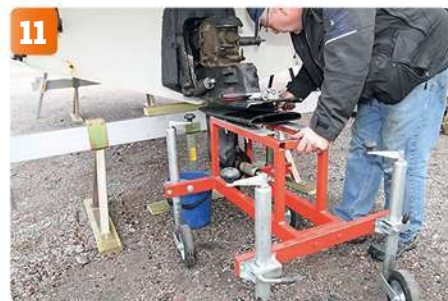
11 Skjut nu in drevvagnen under drevet och justera den så att drevet är avlastat.
