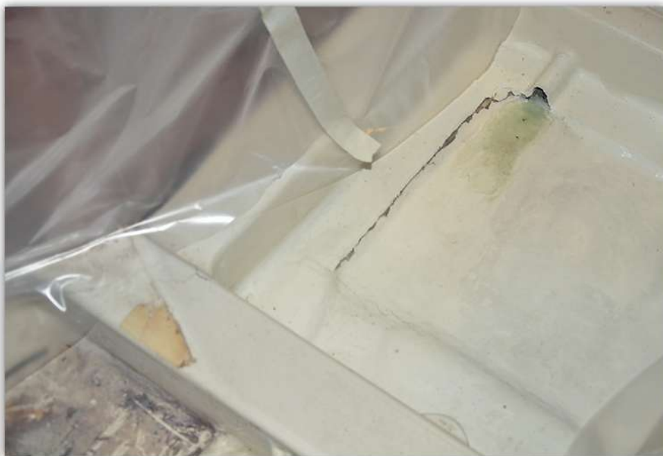
På båtar med innerliner händer det att hela modulen släpper vid grundstötning och måste tas ur i sektioner.
