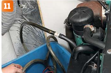
11 Nu ska oljan bytas medan motorn är varm. VP D6 310 har en slang som sitter på den lägsta punkten av motorns oljetråg. Där ansluts oljepumpen.
