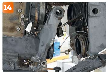
14 Dra sedan vagnen bakåt och drevet är loss. Det kan nu fraktas till lämplig vinterförvaring eller service.
