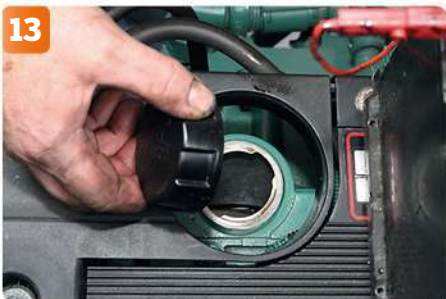
13 Genom att öppna oljepåfyllningslocket och släppa in luft går tömningen lite fortare.
