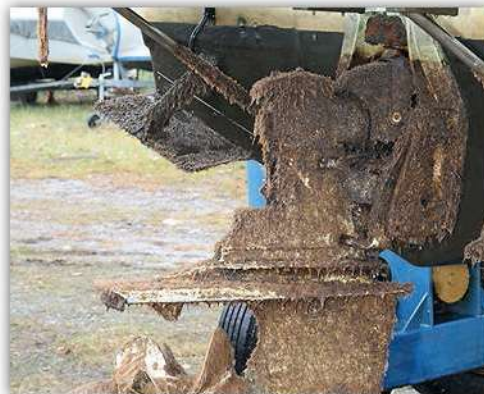
Det här drevet har legat stilla under större delen av säsongen på grund av trubbel med styrningen. Därav den rika växtligheten.
