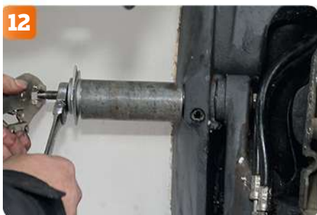
12 Demontera spindlarna/tapparna utåt. Med ett verktyg konstruerat av en lång bult med mutter, en grov rörstump och en stor bricka kan tapparna dras ut.
