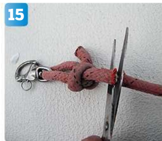
15 Sedan är det bara att börja med det roliga, att trä i nya fall och skot. Klippis skothaken bort från det gamla genuafallet behövs ingen pilotlina.
