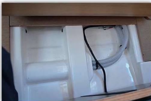
Innerlinermodell som limmas mot ytterskrovet. Snyggt och lätt att hålla rent, men det är svårt att veta om vidhäftning råder efter en grundstötning.
