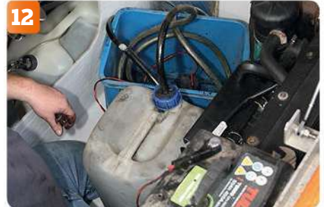
12 Eftersom det är en stor motor med mycket olja, cirka 20 liter, använder vi en elektrisk pump.
