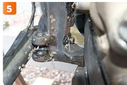
5 Ta på samma sätt loss saxpinnarna och tapparna som håller trimcylindrarna, så att dessa lossas från drevet.
