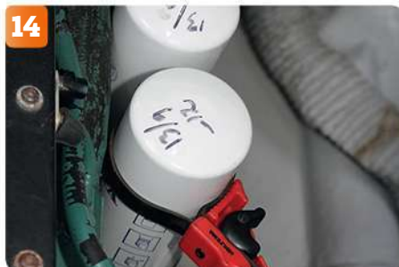
14 Lossa oljefiltren. D6:an har dubbla och ett är ett by-pass-filter. Filtren har olika dimension på gångorna för att undvika förväxling.
