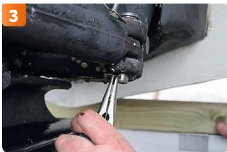
3 Ta loss saxpinnarna som sitter i tapparna som håller styrcylindrarna.
