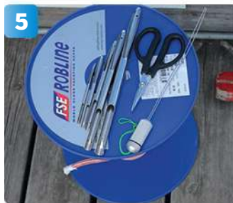
5 Nästa steg är att ta fram olika verktyg som används för att splitsa det nya dyneemafallet.
