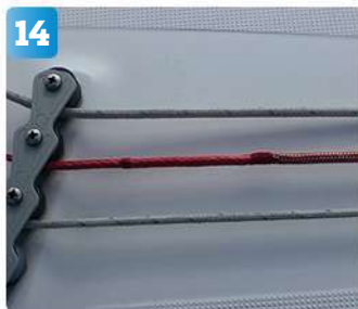
14 Det gamla fallet avlägsnas från den nya röda falllinan som dras till sittbrunnen. Storseglet hissas upp med den nya falllinan. Lägg märke till den splitsade skarven mellan höljet och kärnan i fallet.
