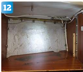
12 Efter att ha lossat bultförbanden och slangens från toan är tanken borttagen från sin plats. Ett utmärkt tillfälle för rengöring av detta utrymme som sällan öppnas, och samtidigt kontrollera sockerbitens anslutningar.
