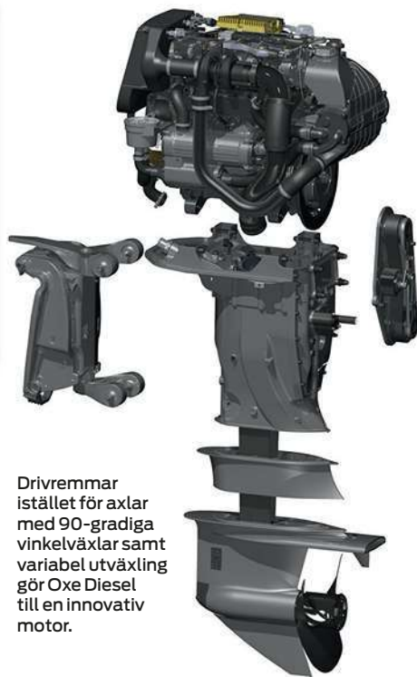
All service kan skötas till havs från motorns front.
