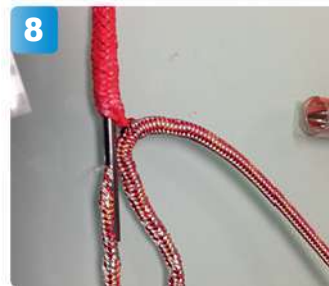
8 Därpå sticks den korta delen av höljet in i kärnan.
