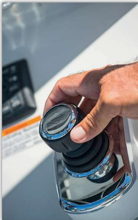
Tack vare dubbelmontage och dagens avancerade motorstyrning kan även båtar med utombordare utrustas med joystick för manövrering i hamn. Då motställs motorerna och körs individuellt så att båten kan precisionsförflyttas i sidled efter förarens behag.
