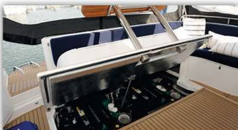
På akterdäck finns soffa och under durken finns motorerna. Med ett enkelt knapptryck åker durk och bord upp och motorerna kommer fram.
