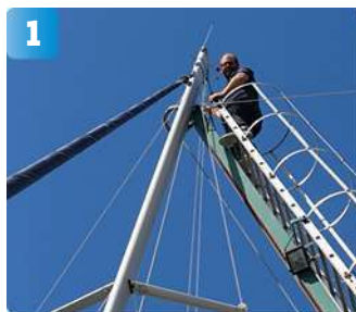
1 Så fixar du ett nytt storfall. Kristian klättrar upp till masttoppen och kontrollerar att den befintliga trissan fungerar som den ska.
