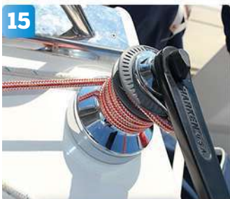
15 Höljet finns alltså kvar en bit i fallet före avlastaren och fallvinschen. På så sätt kan avlastaren låsa falllinan bättre då seglet är upphissat i masttoppen. Man får också ett bra grepp för händerna på falllinan.
