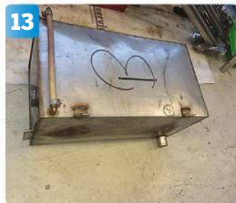
13 Septiktanken på svetsverkstad. Den lilla ringen med ett x är den utmätta positionen för den nya rökröken.
