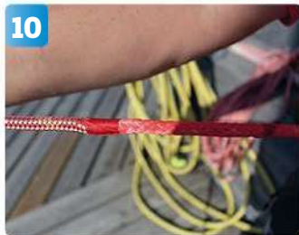
10 Mats drar tillbaka höljet och syr en tagling över skarven. Poängen med den här åtgärden är att höljet ska finnas kvar en bit i fallet innan avlastaren i sittbrunnen. I övrigt består alltså hela fallet av den starka röda kärnan, medan det mesta av höljet har avlägsnats.
