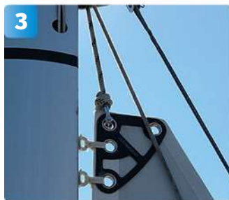
3 När Mats skotar hem storseglet i sittbrunnen så töjer sig polyesterfallet. Seglet "hasar" ner efter samma principer som det skulle göra under en vindby. Fallinan skulle kunna töja sig betydligt mer under en tuff segling.
