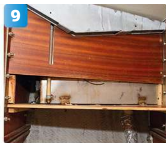
9 Nu går det att ana hur tanken är fastsatt. Den enkla, "analoga" nivåmätarlang är tyvärr inte genomskinlig längre. För att få bort nästa panel måste vi även montera bort röstjärnet i taket.
