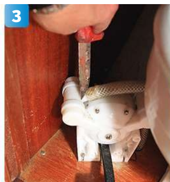
3 Slangen från fotpumpen satt hårt och fick skäras upp.
