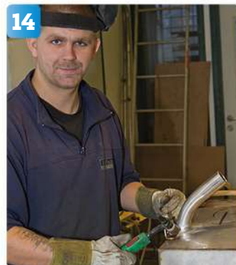
14 Patrik på Båtfixaren utför operationen och svetsar dit en ny röranslutning i rostfritt.
