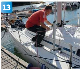
13 Det gör man för att med det gamla fallet kunna dra upp dyneemafallet genom masten.
