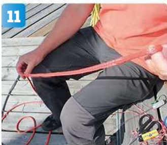
11 Sedan är det dags för Mats att avsluta med en rörsplits i änden som bara består av kärnan. I den änden fästs ett fallschackel.
