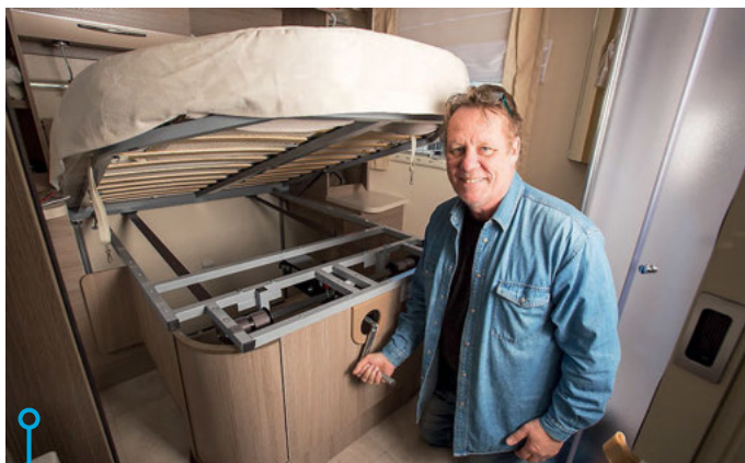
Sängveven höjer och sänker dubbelsängen i Chausson vilket i sin tur påverkar storleken i garaget.
