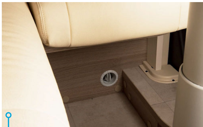
Ett antal strategiskt placerade utblåsgällar för Chausson som drivs med luftburen dieselvärmare från Eberspächer.
