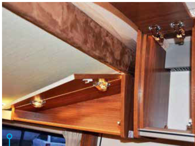
Ett par av överskåpen har ovanlig form. Ingen av dem har luftspalter eller distansskivor.
