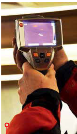
En värmekamera visade hur värmen spred sig.
