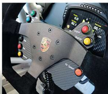
▲ Knappar för torkare, helljusflash, radio, backväxel, alarm-acknowledge, menykontroll, Pit Speed ... Bakom ratten skymtar den nya instrumentpanelen från Cosworth.
