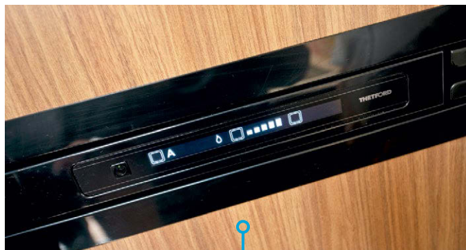
Med ett stort A på kylskåpet väljer skåpet automatiskt energi, 230V, 12V eller gas, gäller bägge bilarna.
