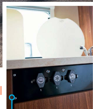
Märklig placering av gaskranarna i Carado.
