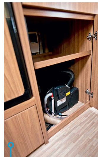
Värmepannan i Carado ger 6 kW, i Sun Living ger den 4 kW.
