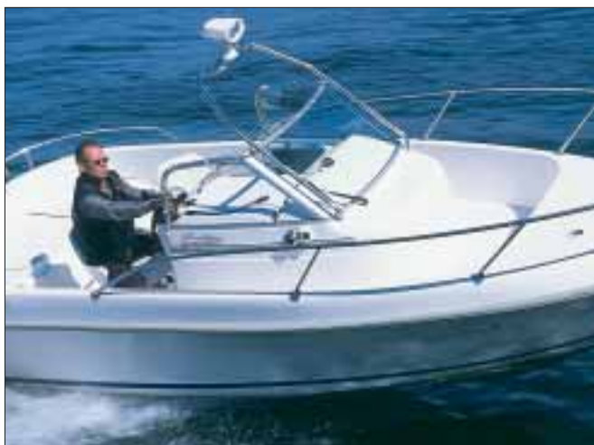
Mittpulpeten är relativt hög. Man sitter lågt. Eftersom gasreglaget sitter på pulpeten blir körställningen sittandes obekväm.
