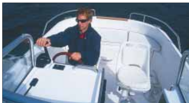
Mittpulpeten är relativt hög. Man sitter lågt. Eftersom gasreglaget sitter på pulpeten blir körställningen sittandes obekväm.
