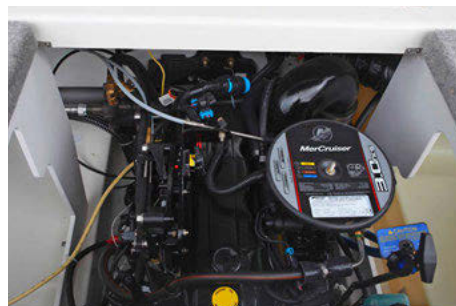
Mercruiser 3.0 L på 135 hästar ger 37 knop på topp. Detta är standardmotorn på mindre jänkare.
