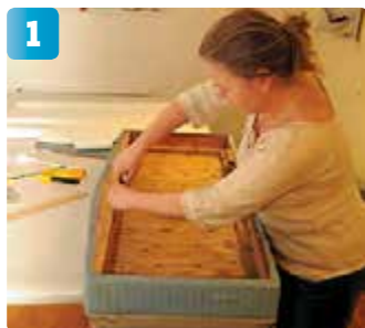
Dynorna på Polar 17 har en klädd sockel. Kristina börjar därför med att demontera samtliga delar i sitstommes om med en skruvmejsel.
