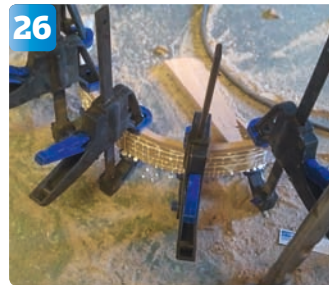
26 För att innehållet i lådan inte ska trilla ner i hålet limmar han ihop en sarg av böjda plywoodbitar.
