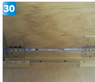
30 Längst ner på locket har Fredrik satt ett stopp med två gångjärn.
