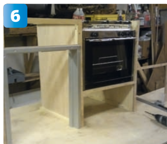
6 Fronten bygger han sedan på för att kunna resa hela konstruktionen upp. Han testar att spisen och ramen till kylskåpet får plats.
