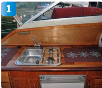
1 Det gamla pentryt var för lågt och saknade passagerarplats och plats för ugn.
