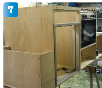
7 Skivan som modulen byggs på sågas loss och skruvas fast och blir på så sätt golv till konstruktionen.
