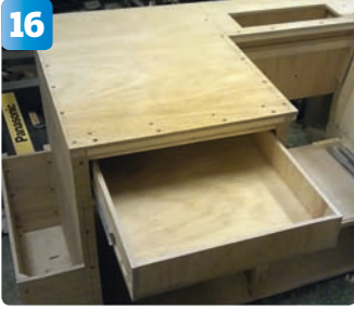
16 Nästa steg är att fästa skenorna till lådorna. De är fastskruvade på trädistanter på stommen för att komma ut en bit.
