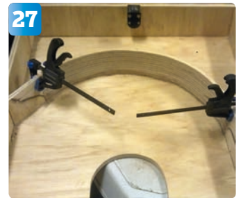
27 Sargen är klar och ska limmas på plats. Anledningen till att han har lämnat så stort utrymme är att själva hon ska få plats i lådan.
