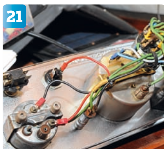
21 Panelen är återställd till sitt originalskick. Nu ska vi bara göra ett funktionstest. Observera den svarta kabeln som nu går direkt från minusanslutningen på varvräknaren till tankmätaren.
