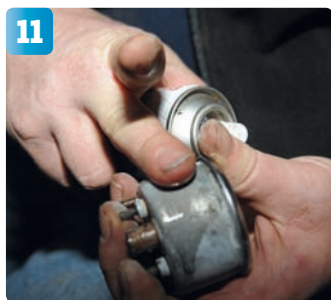
11 Samtliga instrument rengörs med en scotchbrite/grönsvamp och rostlösande olja typ 5/56.
