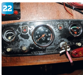
22 Samtliga instrument, varningslampor och strömbrytare funktions-testas. Nu återstår bara att snygga upp panelens yttre med lite färg.
