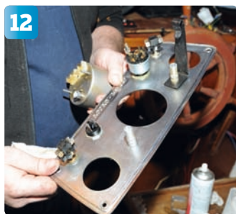
12 Vi lossar samtliga instrument och rengör även panelen från allt fett och smuts.
