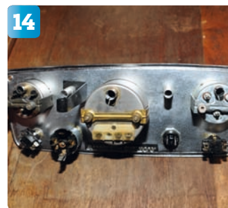
14 Panelen efter rengöring, ren och snygg och förhoppningsvis funktionell i många år framöver.
