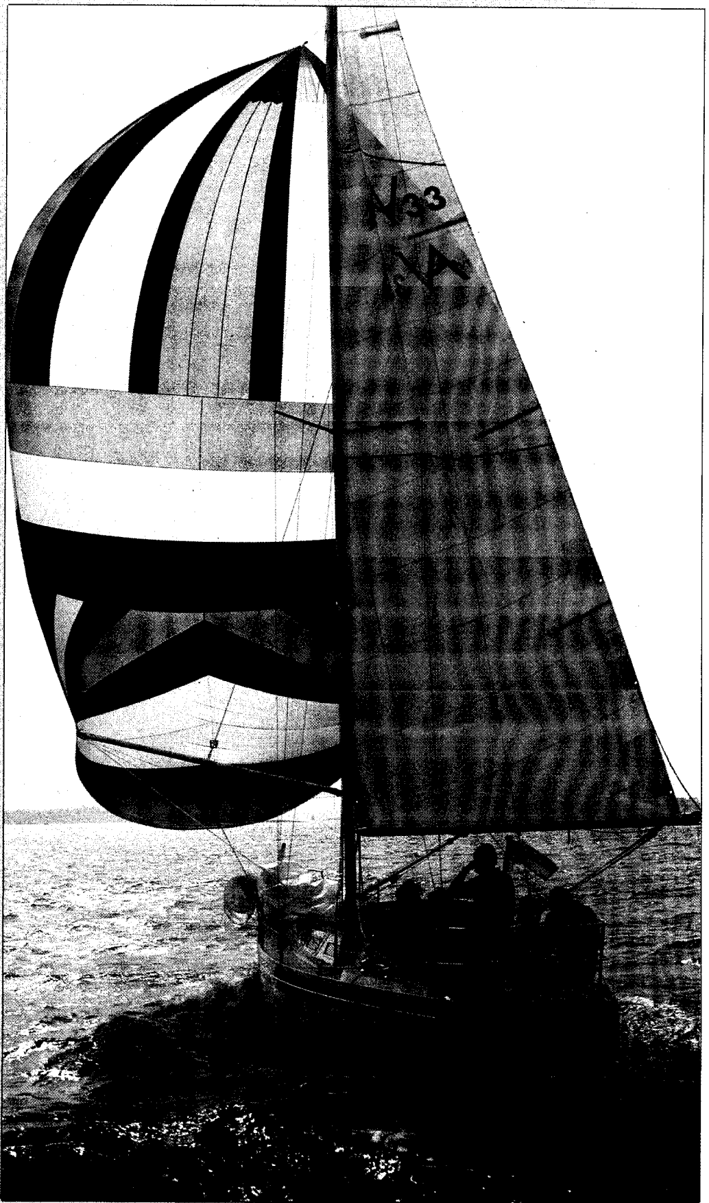
Avance 33 har en modern familjevänlig 7/8-dels rigg med en liten lättskött fock och ett mycket effektivt storsegel.
