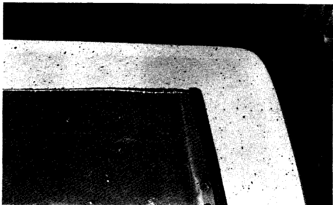
J-Jollens inrede lämnade ett och annat att önska. Den här råa olistade kanten vid akterspeglén är ganska onödig.
