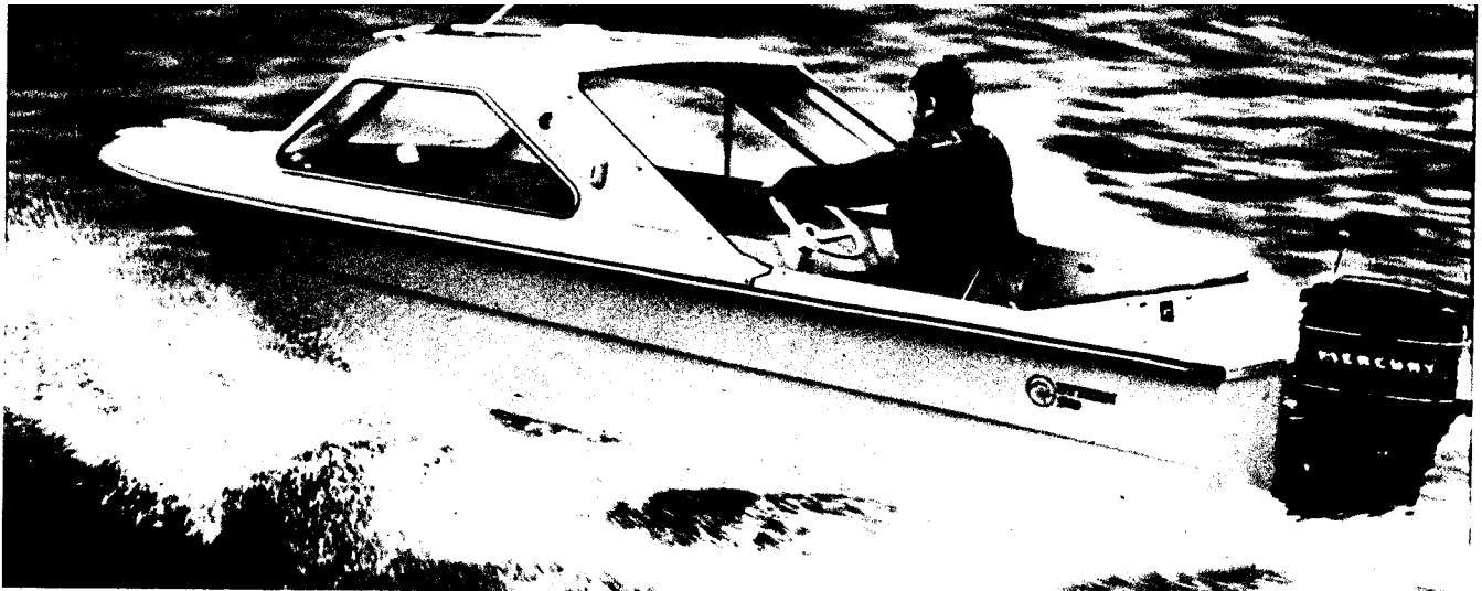
Testbåten var en Uttern 510 botten. Mått: 5,1 x 2,05 m, HT med relativt moderat V-vikt cirka 400 kg.
