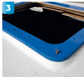
3 Då är det dags att lägga ramen på plats och kolla att allt stämmer.
