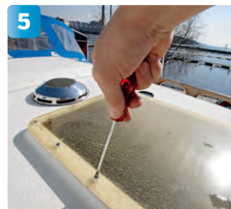
I exemplet fungerade det bäst att lossa inifrån och sedan skruva loss från utsidan.
