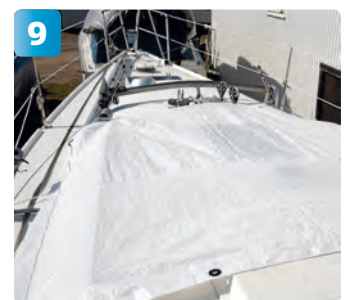
För att kunna lämna båten behöver hålet täckas igen. En uppspänd presenning gör jobbet.
