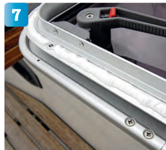
7 Nu ska luckan på plats ovanpå ramen. Börja med att lägga tätningssmassa i skåran runt om.
