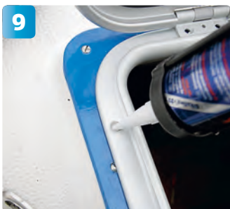
9 Tryck lite tätningssmassa även i skruvhålen ...
