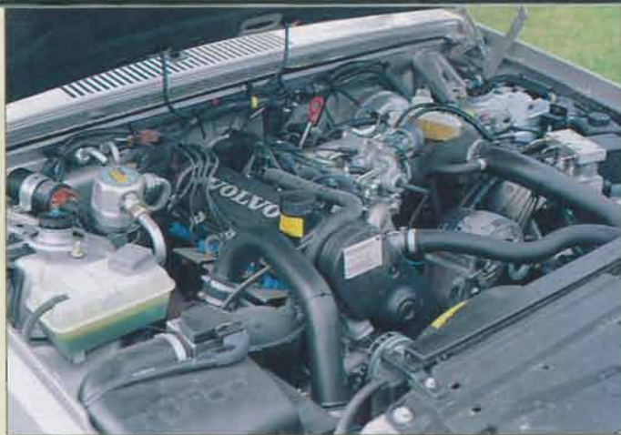
Det är under huven som hemligheten sitter - ett litet turbo som ger god kraft även vid låga varv.
