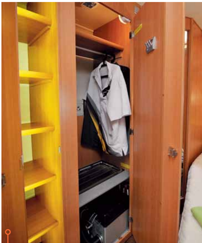
Ett skåp men flera funktioner. Torkskåp med lyse och värme från pannan och ventil i taket. Linneskåp med belysning.
