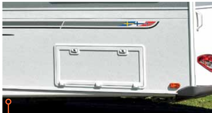
Lastluckan i Knaus ger tillträde till utrymmet under sängen. Luckans storlek är ungefär densamma på de båda vagnarna.
